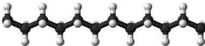
Figura 14. Geometría de los átomos de carbono de la cadena principal de la molécula de polietileno. Tomada de http://arredondomendiola.blogspot.mx/2011/06/dibujos-de-varios-tipos-de-esqueletos.html
