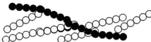
Figura. 18 Tipos de copolímeros. Tomada de http://www.galeon.com/tecnomat/polimeros.htm
